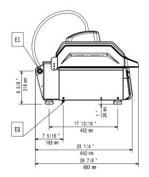
Electrical inlet (power) EO **Electrical Outlet**
